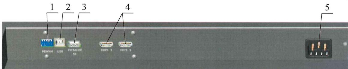
Рисунок 15 — Панель интерфейсов Корунд-С55
