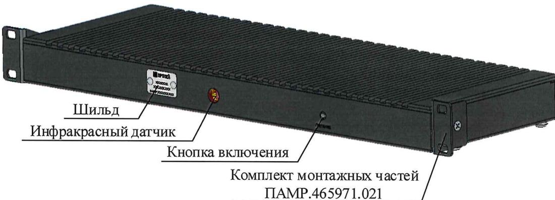
Рисунок 4 — Внешний вид Гранат-С с комплектом монтажных частей ПАМР.465971.021
